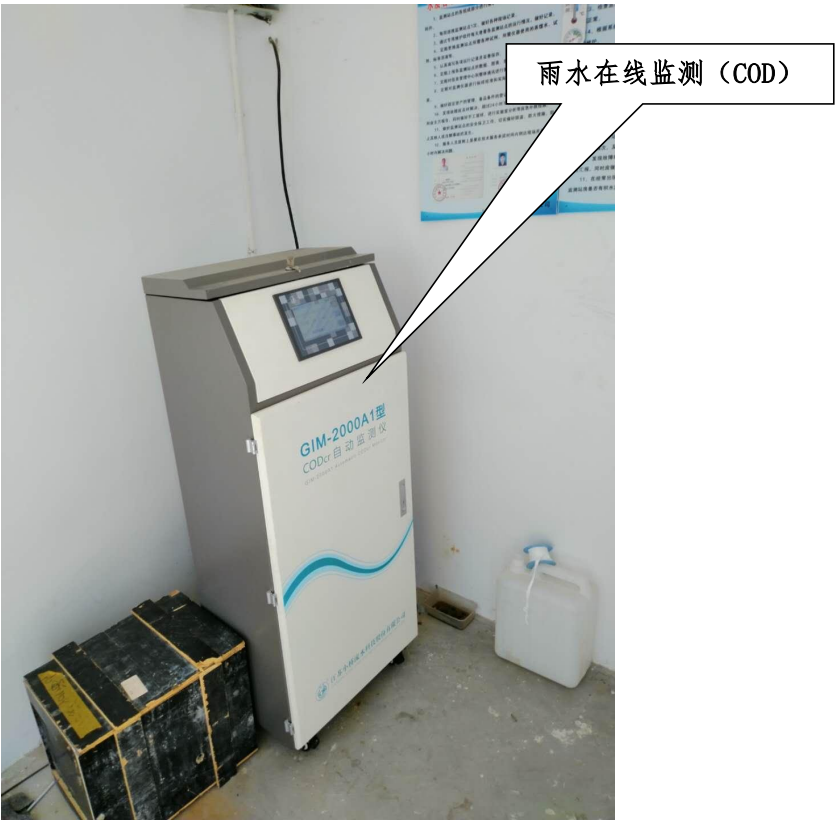
图 4.2-3 废气、污水及雨水在线监测装置设置情况
